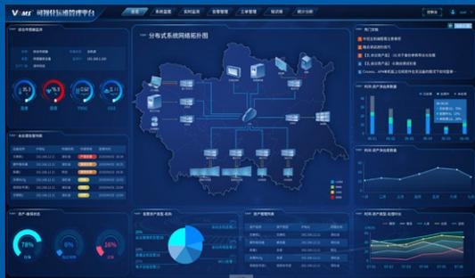
VOMS 可视化智能运维管理平台是淳中科技推出的显控行业首款专业运维管理系统，覆盖了视频、音频、网络、安防、计算机、动环等全生态设备管理，形成统一的资源、拓扑、性能、告警监测；建立从问题监测、故障告警、工单下发、到现场解决与问题反馈的标准闭环运维流程；可有效的将设备、人、业务智能融合，提高运维管理效率、降低系统风险、节约资源成本，将信息化系统运维管理质量提升到更高层次。
