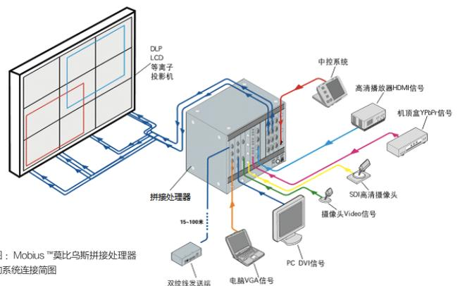
图：Mobius™莫比乌斯拼接处理器的系统连接简图
